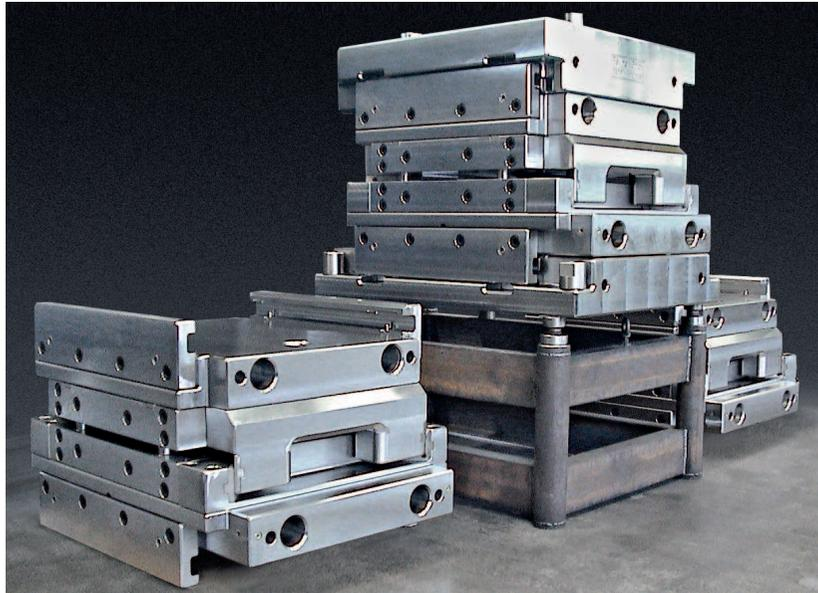
Grundhalter mit eingebauter Rechteckgesenkkassette auf Pressentischattrappe, Grundhalteroberteil in Position: „Pressenstößel unten“, links und rechts daneben einbaubereite, komplette Rechteckgesenkkassetten (Ansicht von vorne-links)
